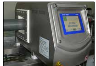
Los sistemas Profile Advantage resuelven el problema de las burbujas y los vacíos en el flujo del producto para eliminar casi por completo los falsos rechazos.
