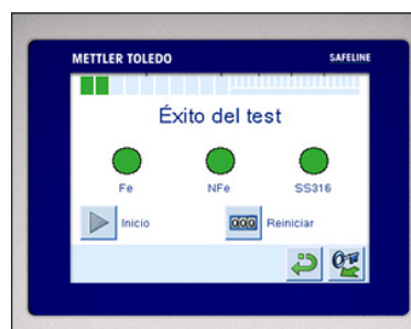
Un mensaje en la pantalla confirma el estado de la comprobación con cada tipo de metal. La luz verde indica un aprobado.
