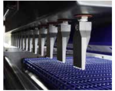
Sistema de rechazo con boquillas y varios chorros de aire
